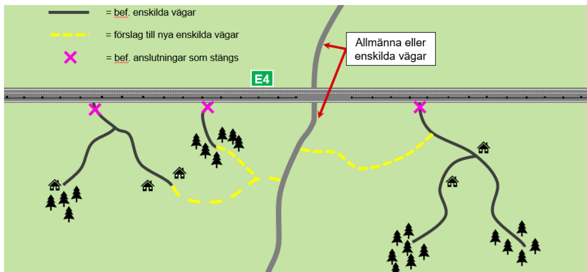
Figur 15. Figuren illustrerar stängningar av enskilda direktutfarter till/från E4 och utfarter från enskilda vägar samt förslag på nya enskilda vägar.
