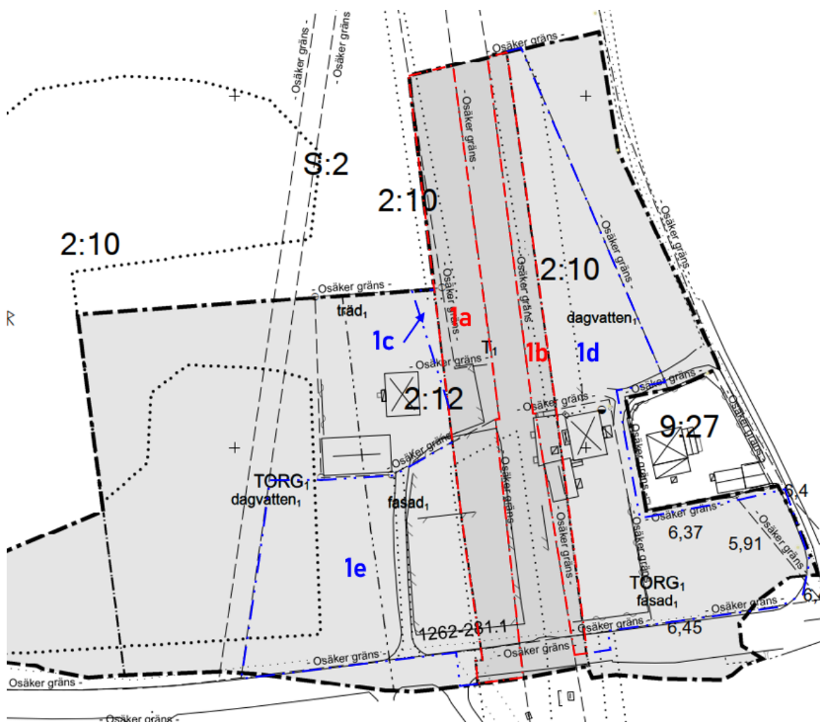
Figur 19. Utdrag ur berörd Detaljplan för del av Fjellie 2:10 med flera i Flädie, Lomma kommun (Flädie stationsområde), 2024 med redovisning av markanspråk från järnvägsplanen: ny järnvägsmark med äganderätt ( röd streckad linje ) och markanspråk för tillfällig nyttjanderätt ( blå streckad linje ).
