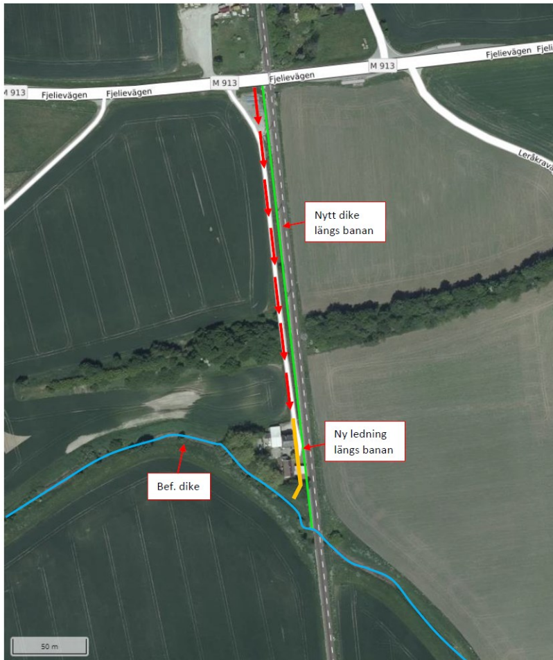
Figur 14. Befintliga dräneringssystem och principiella lösningar för dagvattenhanteringen i Flädie (söder om Fjellevägen) (Sweco).
