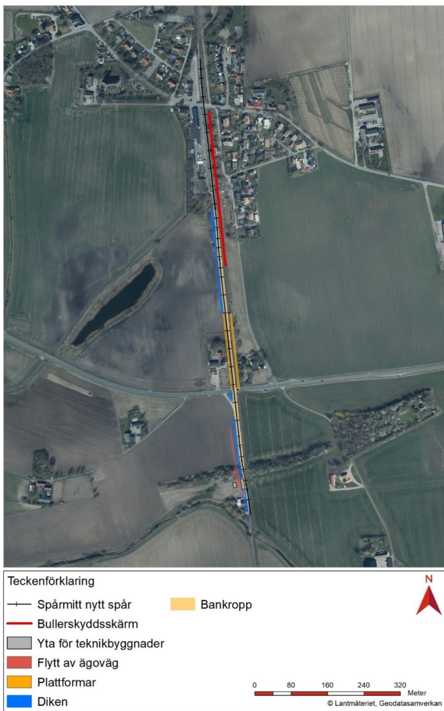
Figur 12. Placering av plattformar, teknikbyggnader och mötesspår (Sweco).
