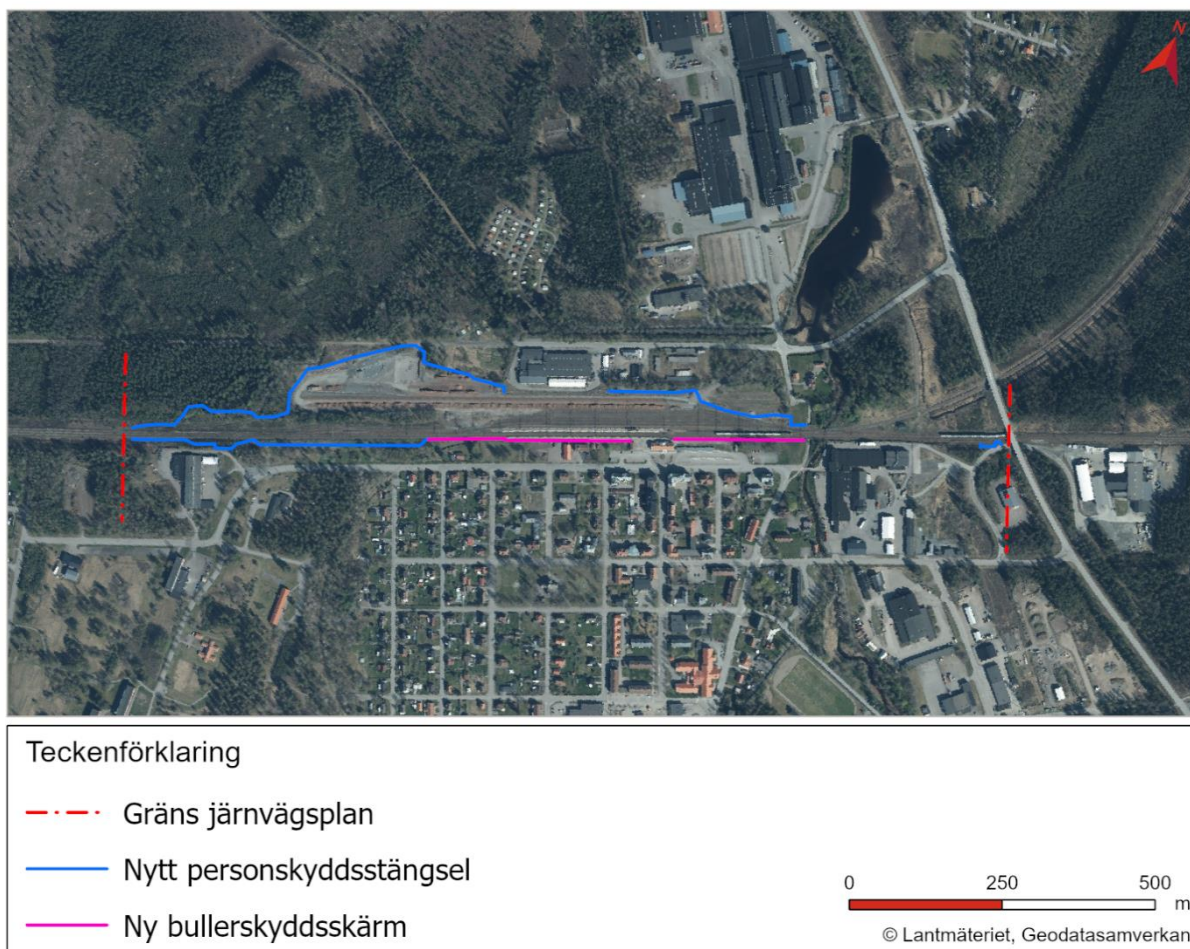
Figur 38. Ny bullerskyddsskärm och personskyddsstängsel runt bangården. Nytt personskyddsstängsel och ny bullerskyddsskärm ansluts till befintligt stängsel norr och öster om bangården.
