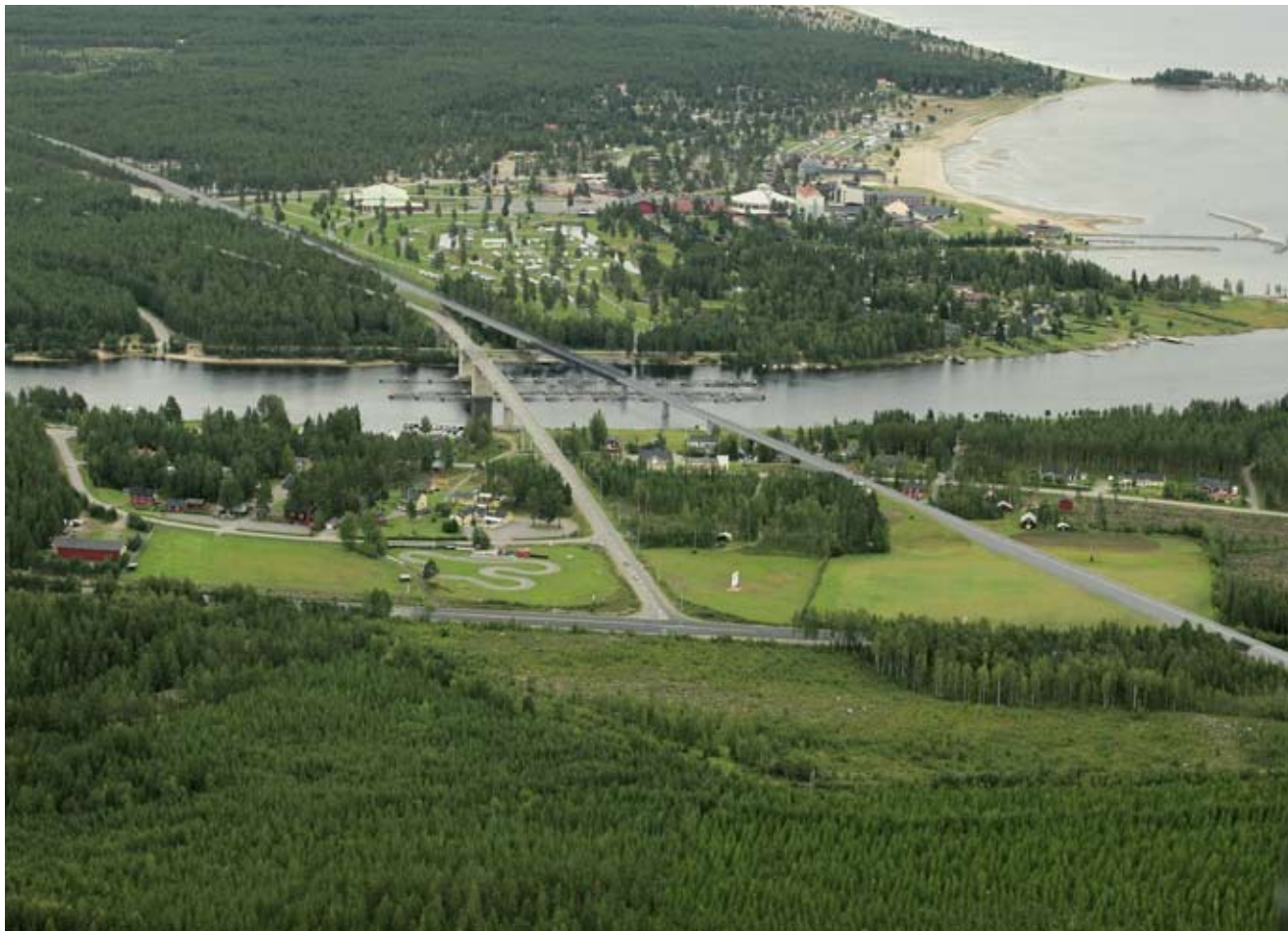
Figur 2.2:1 Fotomontage av järnvägsbro med segelfrihöjd på cirka 8 meter över Pite älven i Pitsund framtagna av Berg AB.
