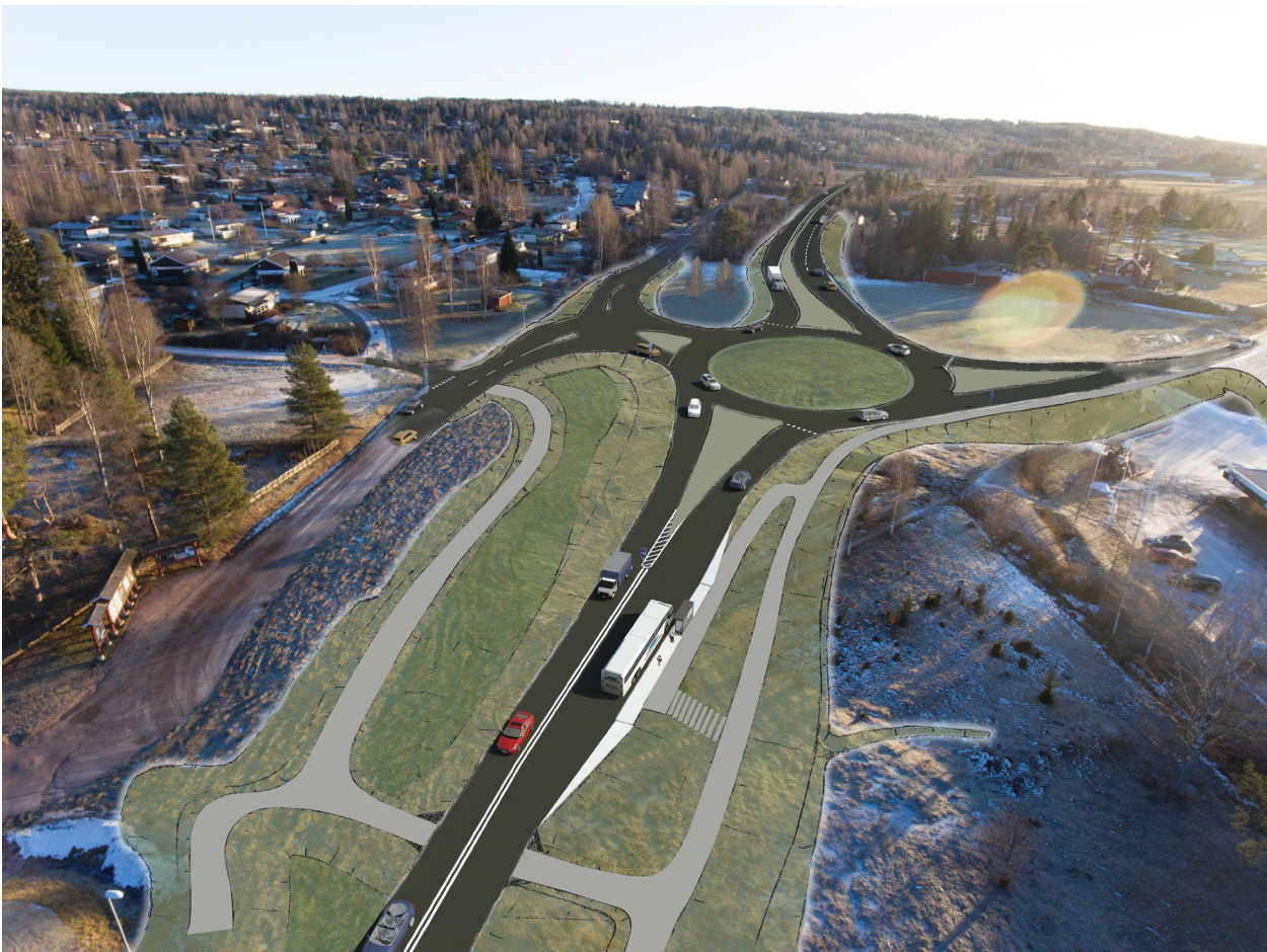
Där delsträcka 3 ansluter till befintlig E45 vid Trunna föreslås en cirkulationsplats som effektivt dämpar hastigheten men samtidigt låter trafiken flyta på. Cirkulationsplatsens grönytor utformas som ängsytor med inslag av enstaka solitärträd eller solitärbuskar med för platsen naturligt växtmaterial.
