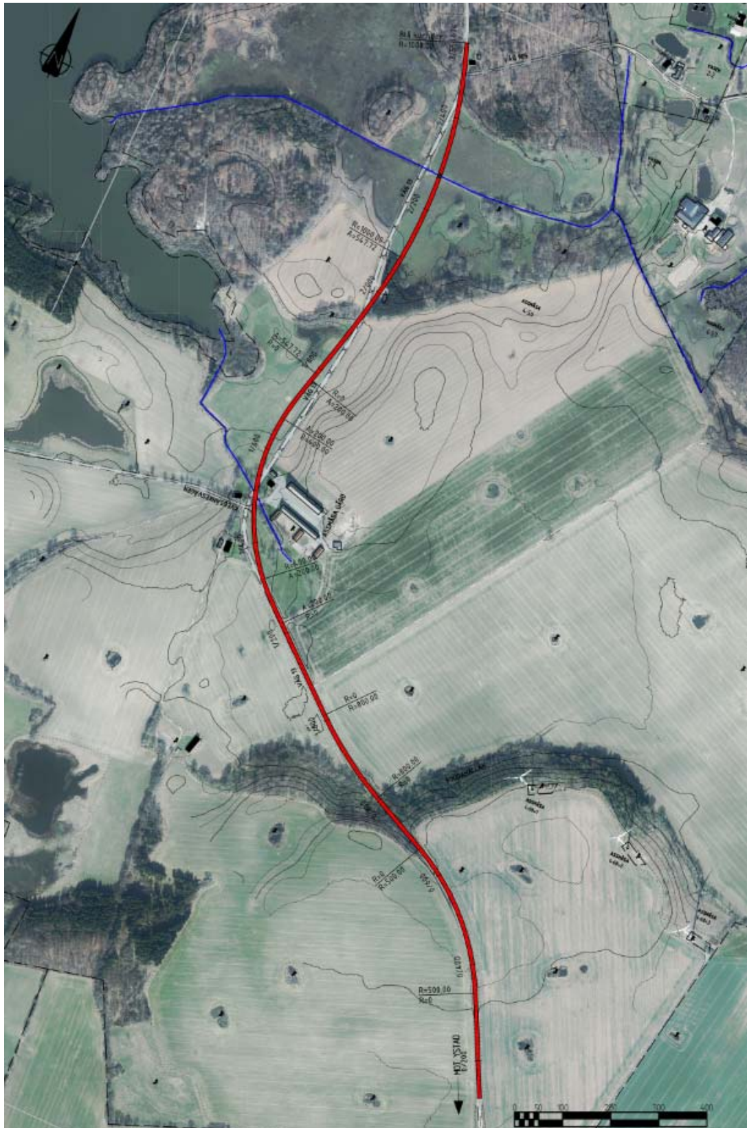
Figur 4.2:1 Planerad vägbyggnad med breddning och delvis nybyggnad av väg intill befintlig väg. Breddad och ny väg är markerad med röd färg.
