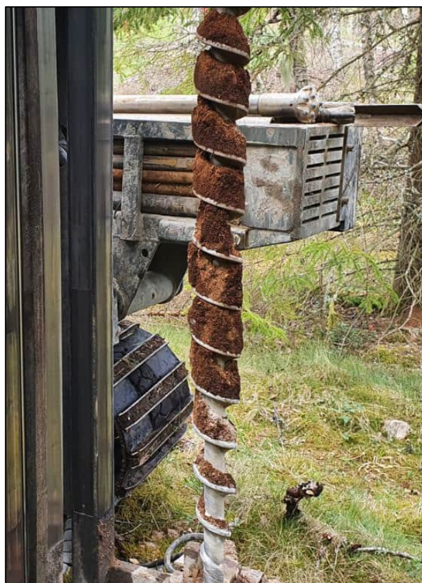
Figur 5 Skruvborrning i provpunkt NC2006.
