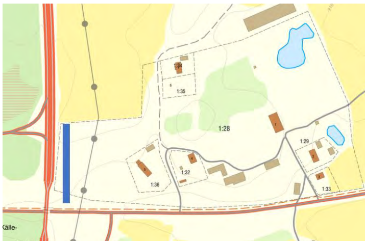
Figur 7. Principiell skiss över föreslagen bullervalls (blå rektangel) krönplacering. Bakgrundskarta: Lantmäteriet via geodatasamverkan ©
