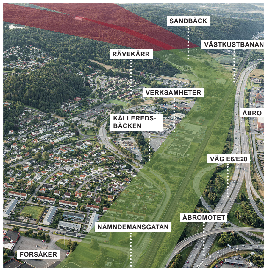
Figur 68. Flygfoto över fokusområdet Råvekärr-Sandbäck, vy mot söder. Den röda färgen illustrerar bergtunnel och den gröna färgen illustrerar ett område där två alternativ finns, antingen en lång bro eller att järnvägen går i skärning och/eller i betongtunnel. (Foto: Per Pixel, 2020)
