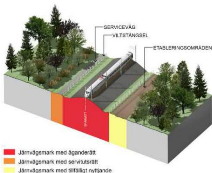
Figur 9.1-1 Principskiss för markanspråk.
