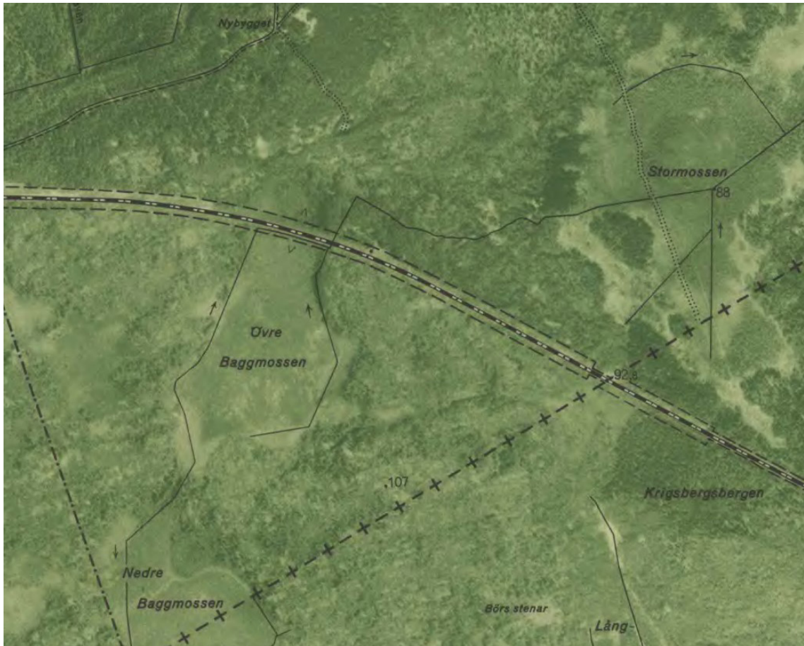
Figur 4.5.24 Utdrag ur den ekonomiska kartan från 1955 som visar att det längsgående diket från västra till östra sidan av Övre Baggmossen ligger inom järnvägsfastigheten (akt nr. Högsjö J133-9F9156, © Lantmäteriet).
