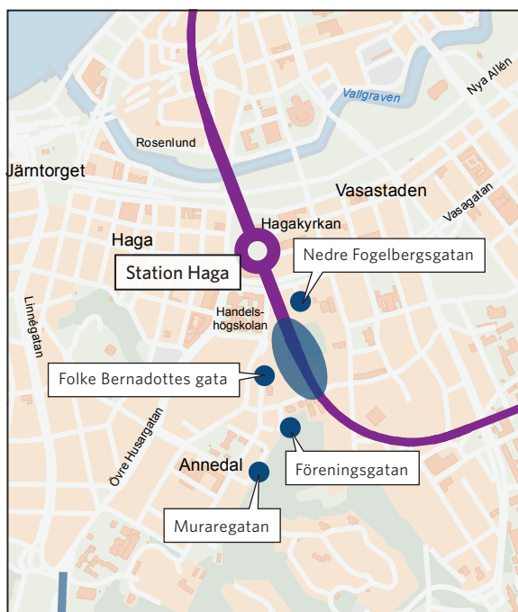
Figur 10. Fyra platser undersöktes för arbetstunnel Haga. Ovalen visar det läge på huvudtunneln där det är önskvärt att arbetstunneln ansluter.
