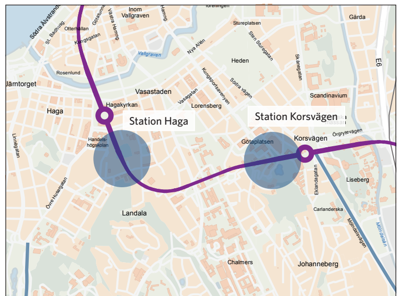
Figur 9. Inom cirkarna återfinns de mest ekonomiska lägena för arbetstunnelns mynning. Gator som kan ta emot byggtrafiken har markerats.
