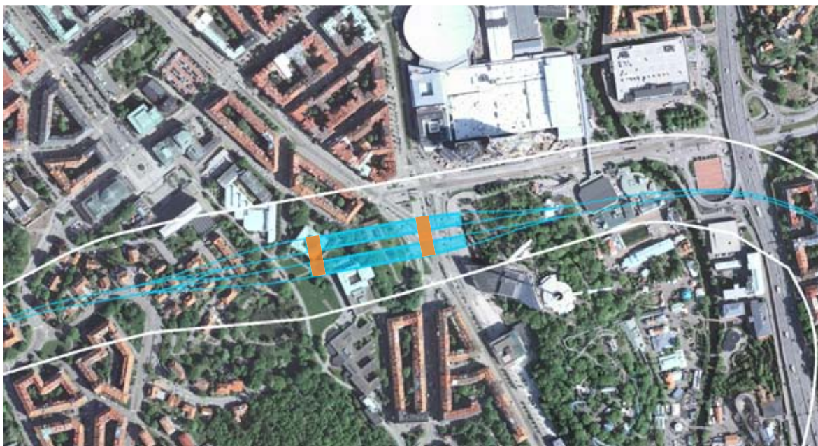
Figur 20. Station Korsvägen placeras i berg men sträcker sig också in under Liseberg. Från stationen är det nära till viktiga besöksmål och bytespunkten Korsvägen. Orange markeringar visar ungefärliga lägen för uppgångar från plattformarna.
