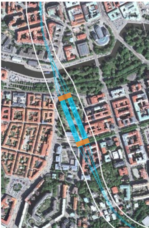
Figur 17. Station Haga kommer att bestå av två spår och en plattform, men precis som Station Korsvägen görs förberedelser för en utbyggnad till en station med fyra spår och två plattformar. Orange markeringar visar ungefärliga lägen för uppgångar från plattformarna.
