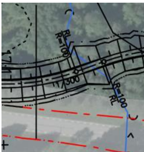
Figur 6.3.3–4. Hamptjärnsbäcken vid planerad passage av GC-vägen. Bäcken är här ca 2 m bred och 0,2 m djup. Rörbron placeras i nära anslutning till den befintliga gångbron. (Foto: Ramboll). Till höger aktuellt läge på illustrationskartan, (km 1/315).
