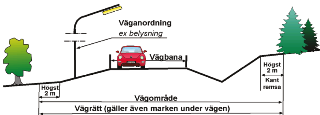
Figur 9.1–1 Vägområdets beståndsdelar. Figuren visar en vanlig väg, men principen är densamma för GC-vägen.
