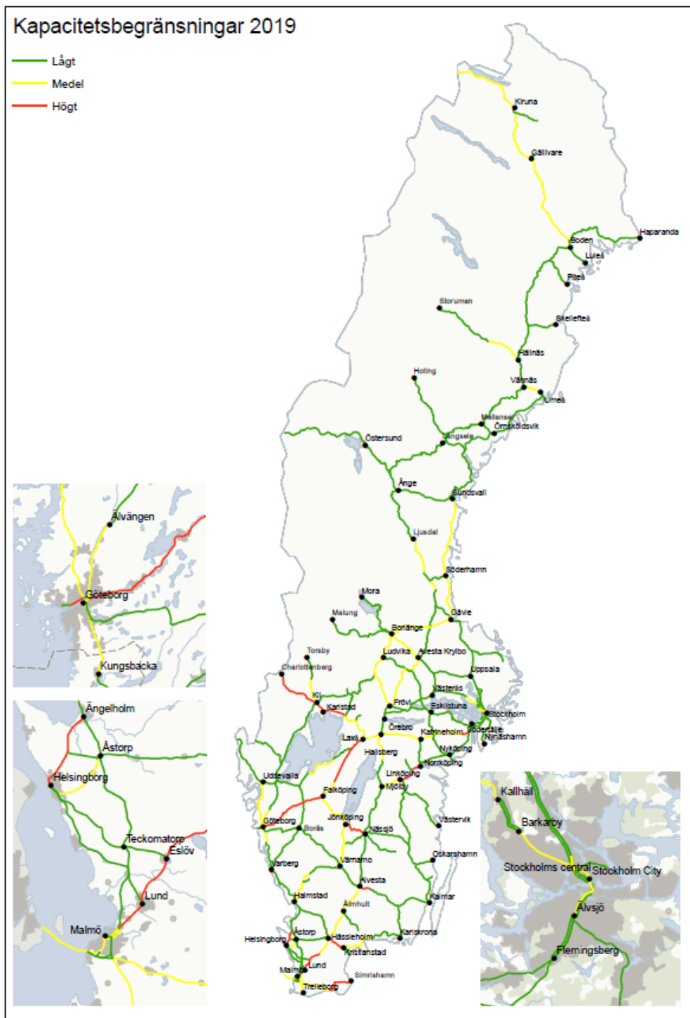
Bild 1: Kapacitetsutnyttjande dygn 2019. Rött = högt kapacitetsutnyttjande, Gul = medelhögt kapacitetsutnyttjande, Grön = lågt kapacitetsutnyttjande
