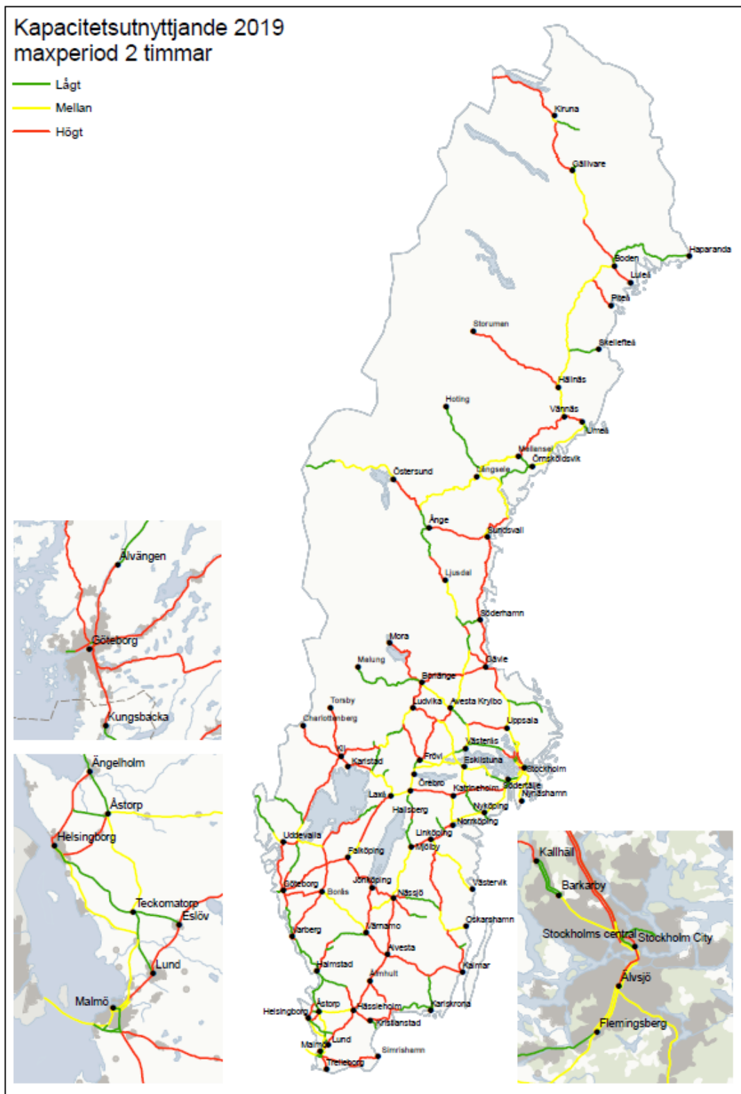
Bild 2: Kapacitetutnyttjande max 2 timmar 2019.
