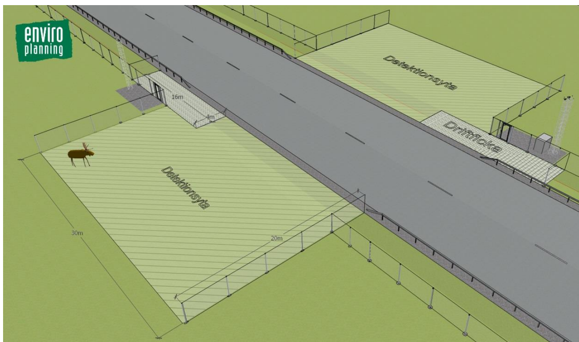
Figur 31: En faunapassage i plan är en typ av faunapassage som kan användas på vägar och järnvägar med låga trafikvolym. Trafikverket arbetar just nu med de tekniska beskrivningarna för denna typ av passage (inkluderad med viltvarningssystem) och tar fram rekommendationer när faunapassage i plan kan vara ett alternativ. Illustration Elin Holgerus, EnviroPlanning AB.
