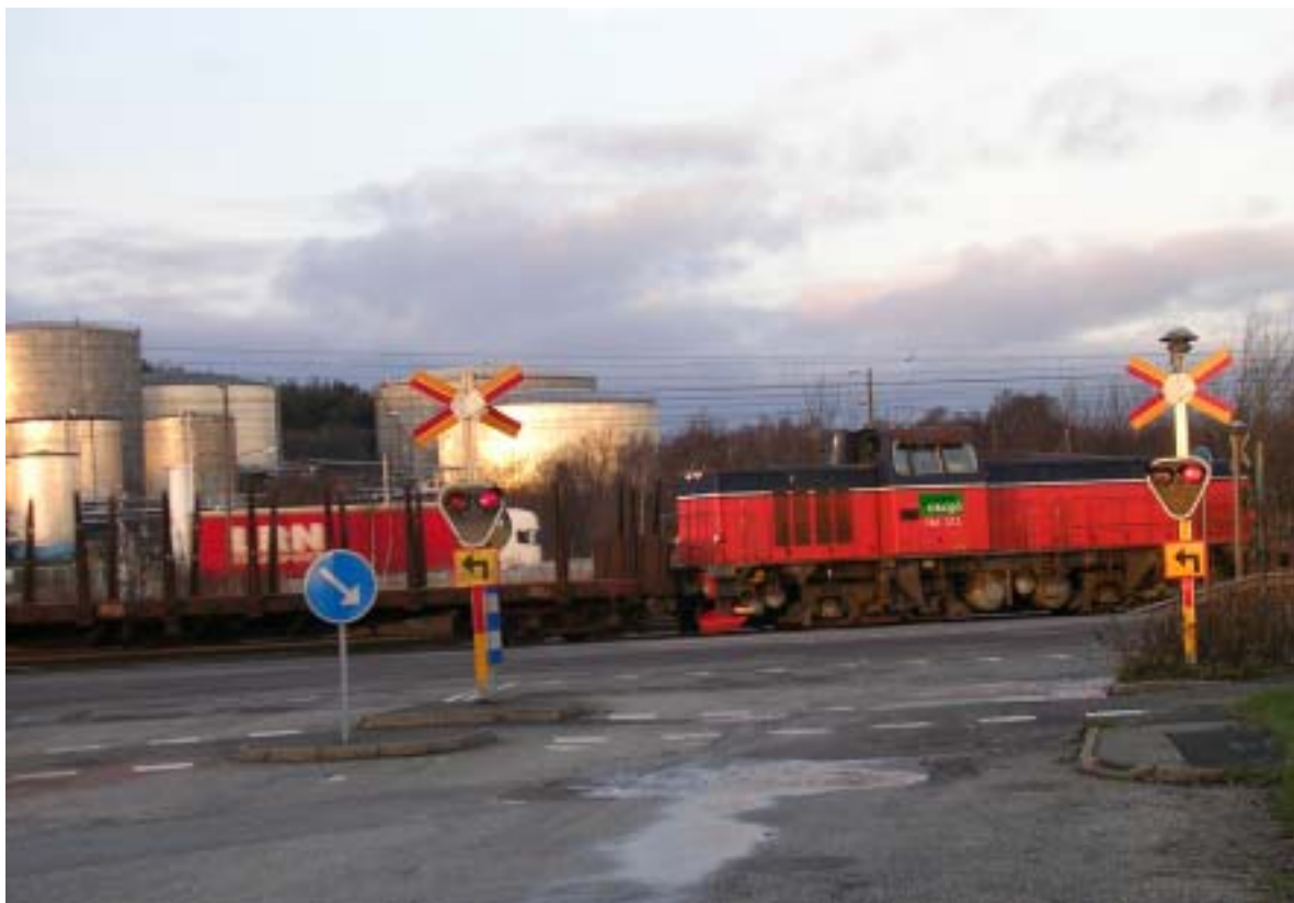
Figur 22 Längst bak kommer det radiostyrda loket och skjuter växlingssättet framför sig.
