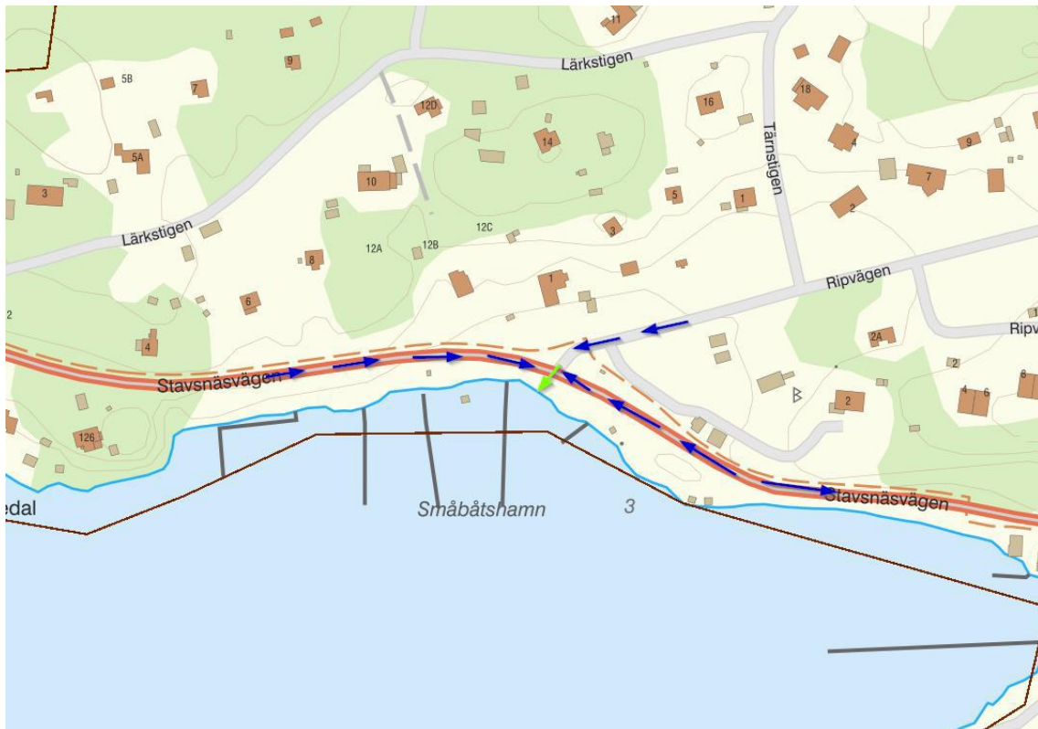
Figur 21. Blåa pilar visar vattnets rörelser från områdena närmast busshållplatserna. Grön pil visar flödesriktning från dagvattenbrunnar i gata.
