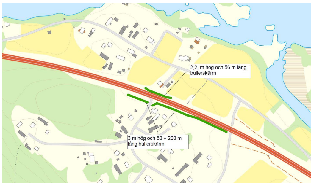
Figur 4. Placering av vägnära bullerskärmar, Månsbyn, km 16/557 – 16/626 och km 16/481 – 16/791
