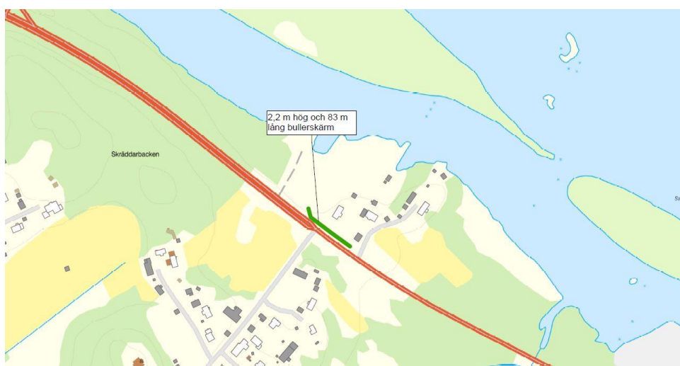
Figur 7. Placering av vägnära bullerskärm, Innanbäcken, km 21/449 – 21/527
