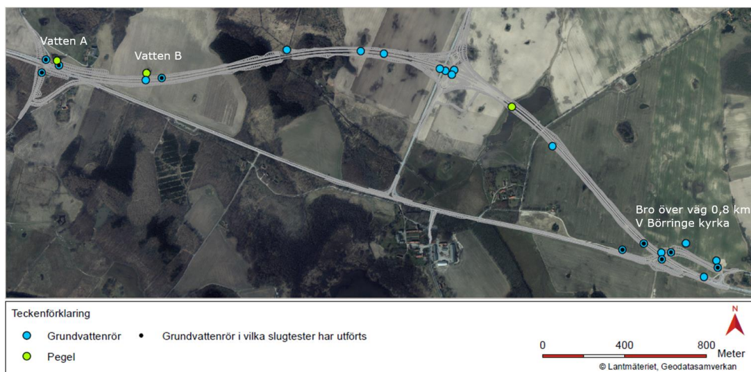
Figur 7. Grundvattenrör och peglar vid ny E65 samt lokaliseringar av de rör i vilka jordens hydrauliska konduktivitet har undersökts.
