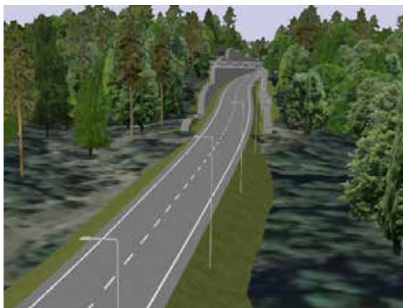
Figur 12. Illustration av väg på bank samt bergskärningen "yxhugget". Gångbron visas schematiskt. Bild från VR-modell.
