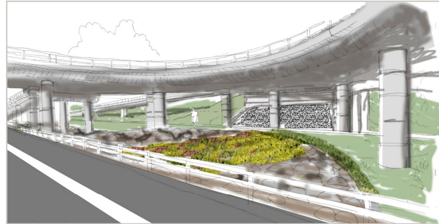
Ovan: Illustration Trafikplats Högsolan i riktning mot Tullinge, Bilden visar den upphöjda stensättningen med sedum samt den bearbetade slättkonen vid brofästet, WSP
