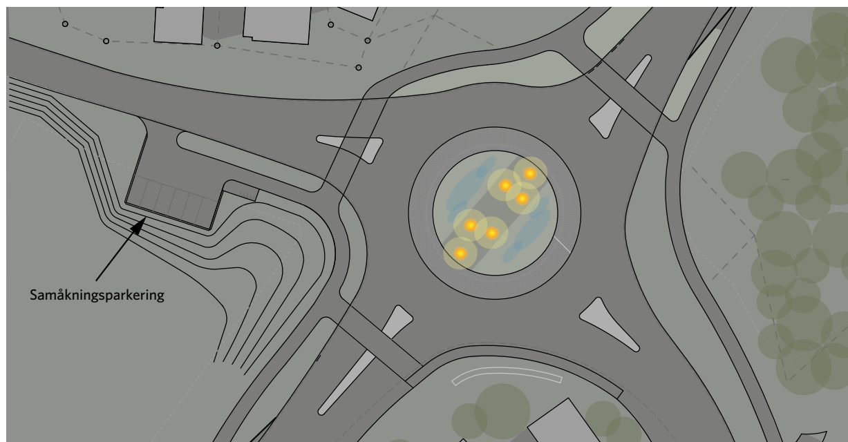
Figur 5.4-3 Skiss över effektbelysning i rondellen.
