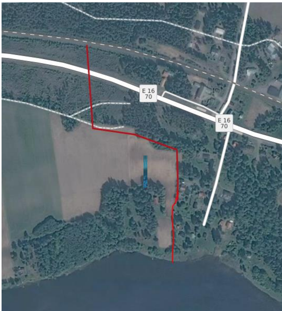
Figur 19 Schematisk bild av självfallsledning/dike från lågpunkt under järnväg till Dalälven..
