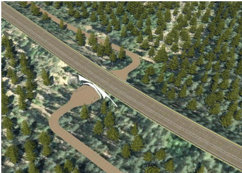
Figur 24. Visualisering som visar planerad åtgärd för skoterled, som föreslås passera E16/ väg 70 via ny planskild passage.
