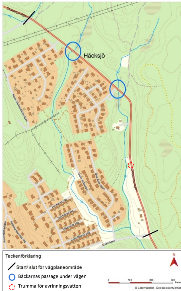
Figur 12. Översiktskarta med norra och södra Häcksjöbäckens passage under vägen markerat i blått. Trumma under vägen som leder avrinningsvatten från östra delen av väg 1937 är markerat i rött.
