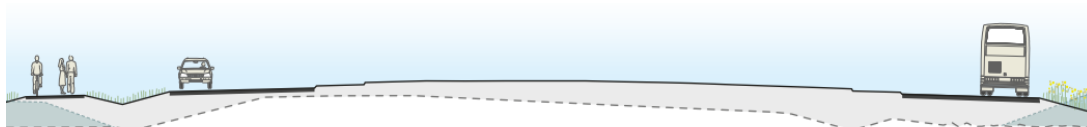
Figur 5.3.4-1 - sektion över ny cirkulationsplats och gång- och cykelväg längs väg 552 (C-C i figur 5.3.1-1)
