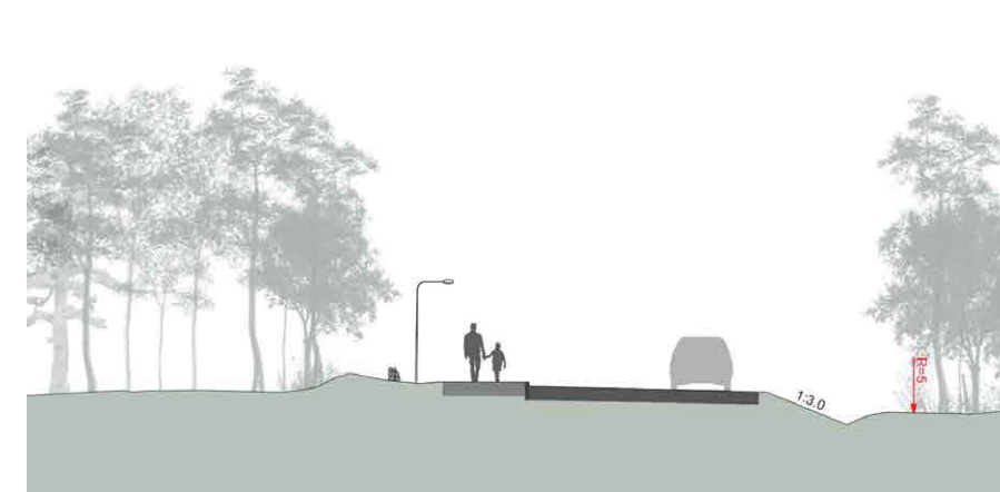
Figur 39. Principsektion från kantstensseparerat GCM-väg vid stenmuren.
