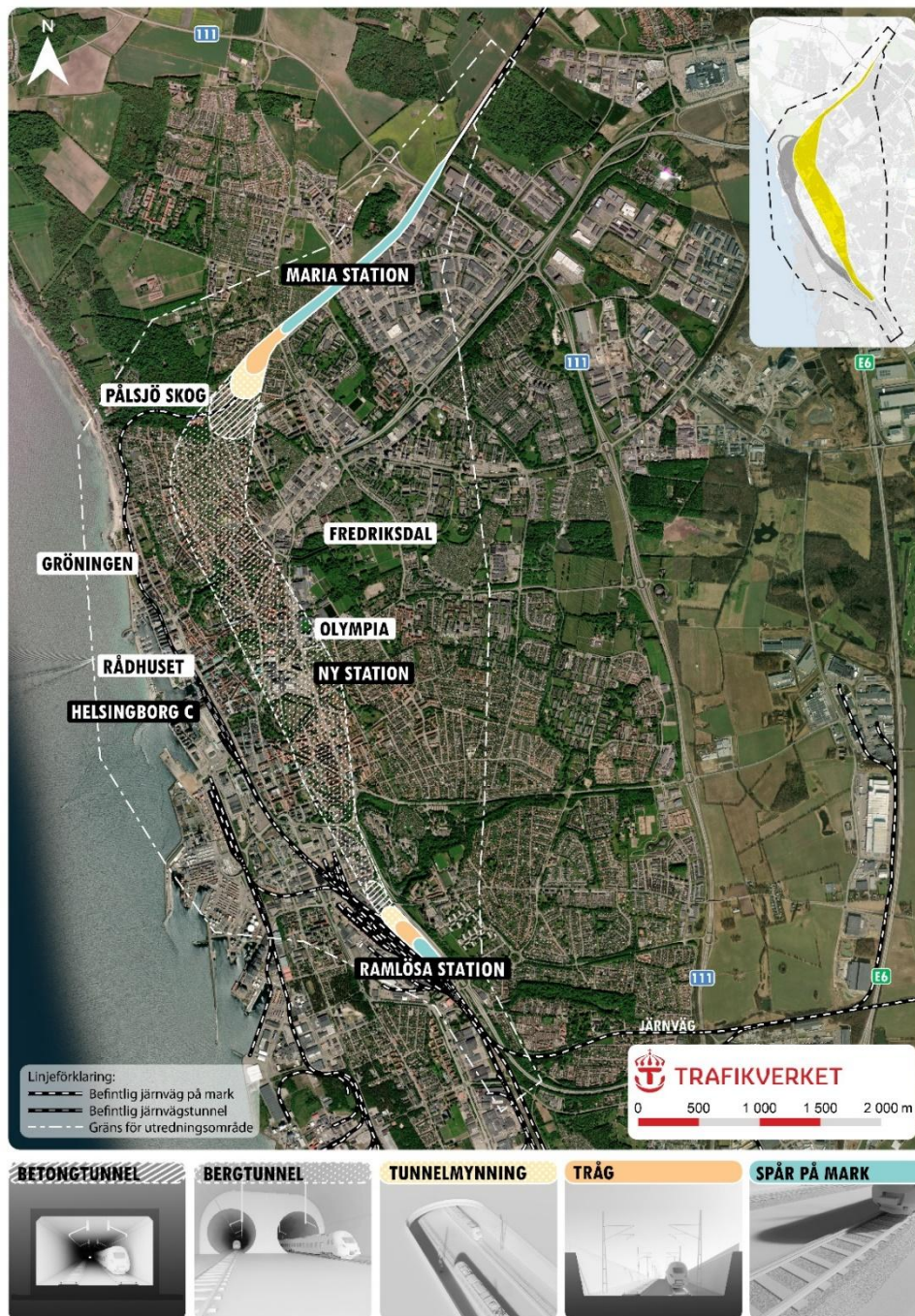
Figur 55. Illustrationskarta över lokaliseringsalternativ Gul, ovan Landborgen. Blå markering avser järnvägsspår på mark, orange avser tråg, gul avser tunnelmynning och skraffering avser tunnel.
