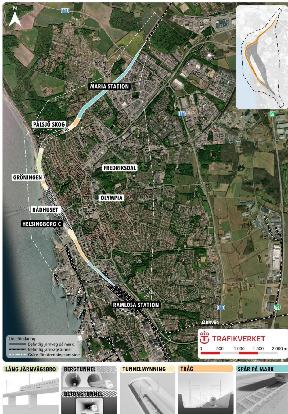
Figur 51. Illustrationskarta över lokaliseringsalternativ Orange, längs med befintlig järnväg med ny tunneldel. Blå markering avser breddning till två järnvägsspår på mark, orange avser tråg, gul avser tunnelmykning, skraffering avser tunnel och grön avser lång järnvägsbro.
