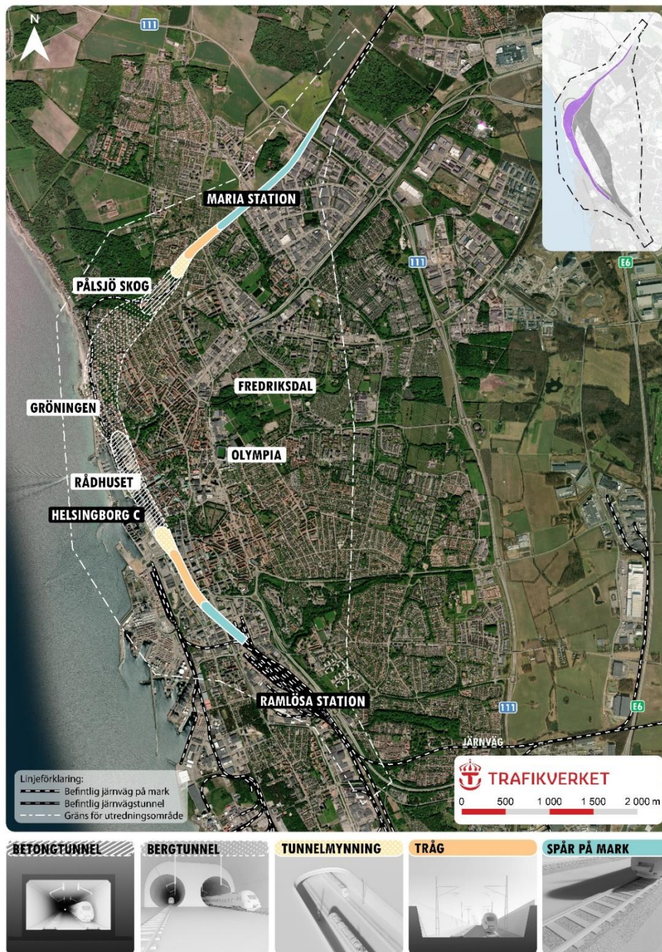
Figur 52. Illustrationskarta över lokaliseringsalternativ Lila, under Drottninggatan. Blå markering avser järnvägsspår på mark, orange avser tråg, gul avser tunnelmynning och skraffering avser tunnel.
