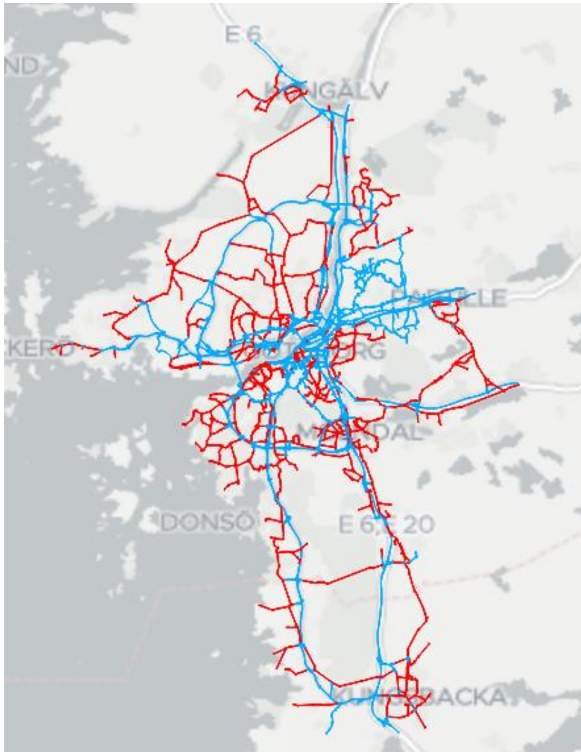
Figur 56: Vägnät år 2040 där blå länkar är manuellt kodade och röda länkar kommer från Emme.
