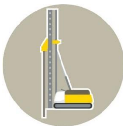
Figur 7. Schematisk illustration av en spontmaskin.
