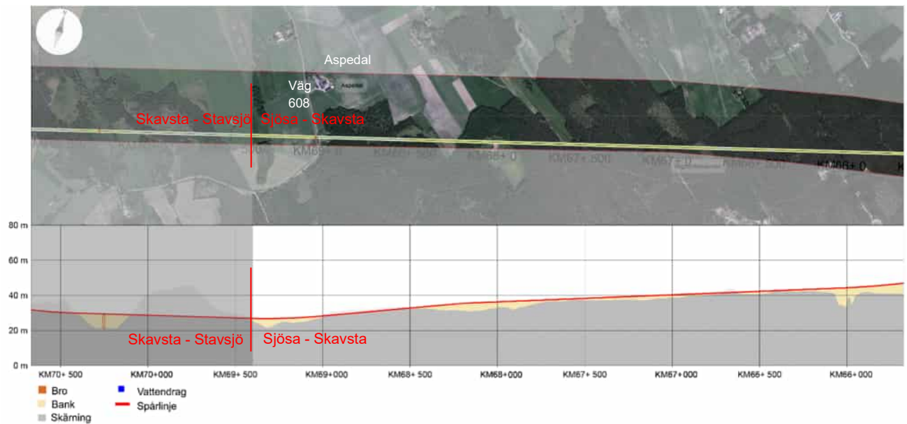
Figur 7. Översikt över plan och profil för stambanan cirka km 66+000 till anslutningen mot delsträcka Skavsta–Stavsjö, röd markering vid km 69+400.
