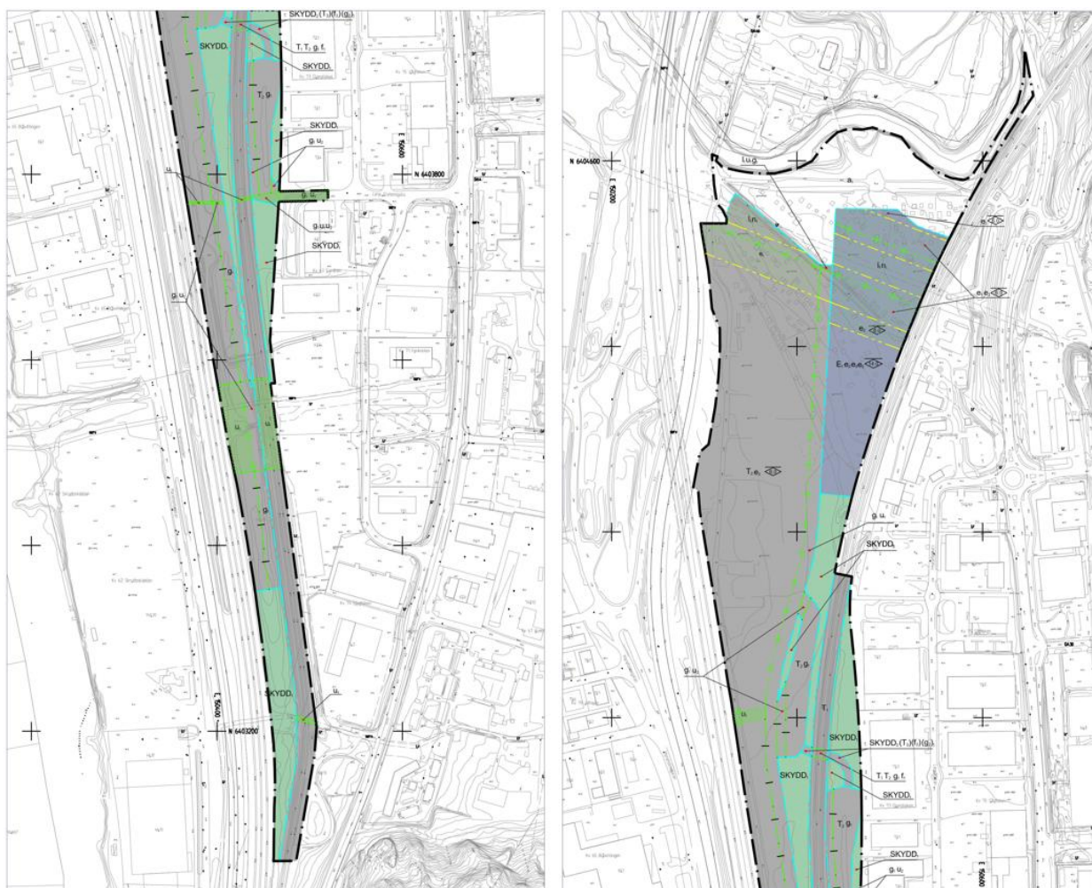
Figur 34. Utsnitt från den nya detaljplanens plankarta (arbetsmaterial 2022-06-01). Järnvägsplanens markanspråk ryms inom detaljplanens markanvändning T2, järnväg.
