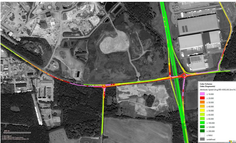
Figur 74. Åtgärds paket 1 under eftermiddagens maxtime med minskat trafikflöde på 10 procent från alla riktningar. Signalschemat i trafiksignalen är samma som idag för att underlätta för ramper.
