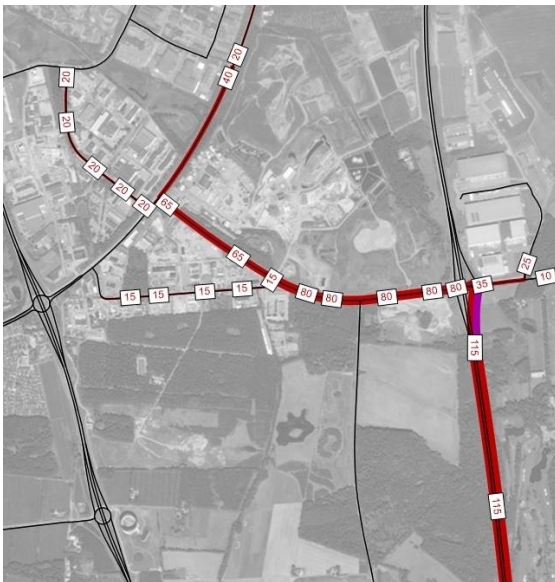
Figur 75. Synliggör enbart all trafik som passerar södra avfartsrampen. Nulägesmodell för år 2020 i makromodellen i Visum.
