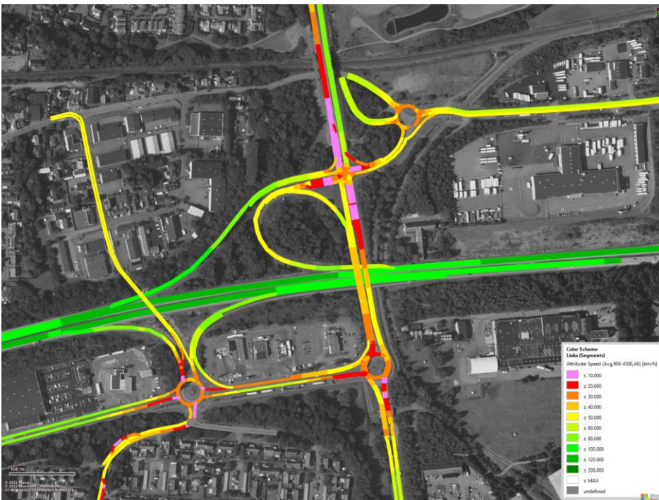
Figur 29. Hastighetskarta för Åtgärdspaket 1 för eftermiddagens maxtimme.
