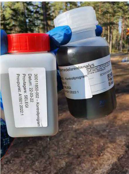
Foto 3. Mycket mörkt vatten från grundvattenrör A1501
