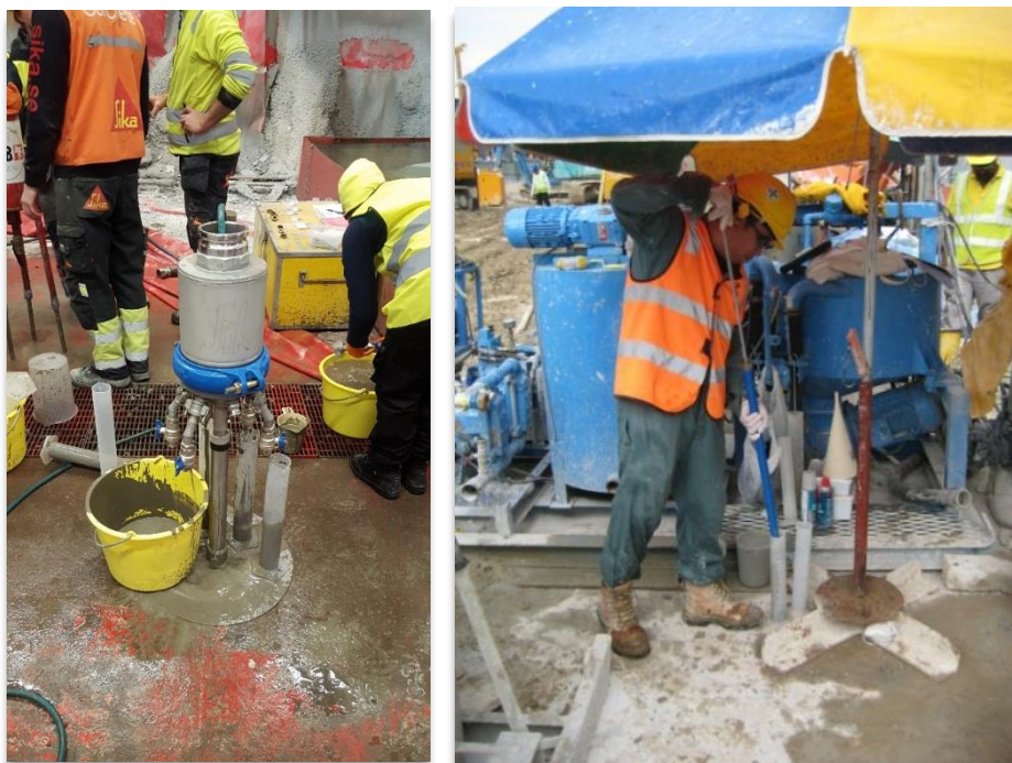
Figur 3-12. Provnings av inträngningsförmåga med filterpress och filterpump.
