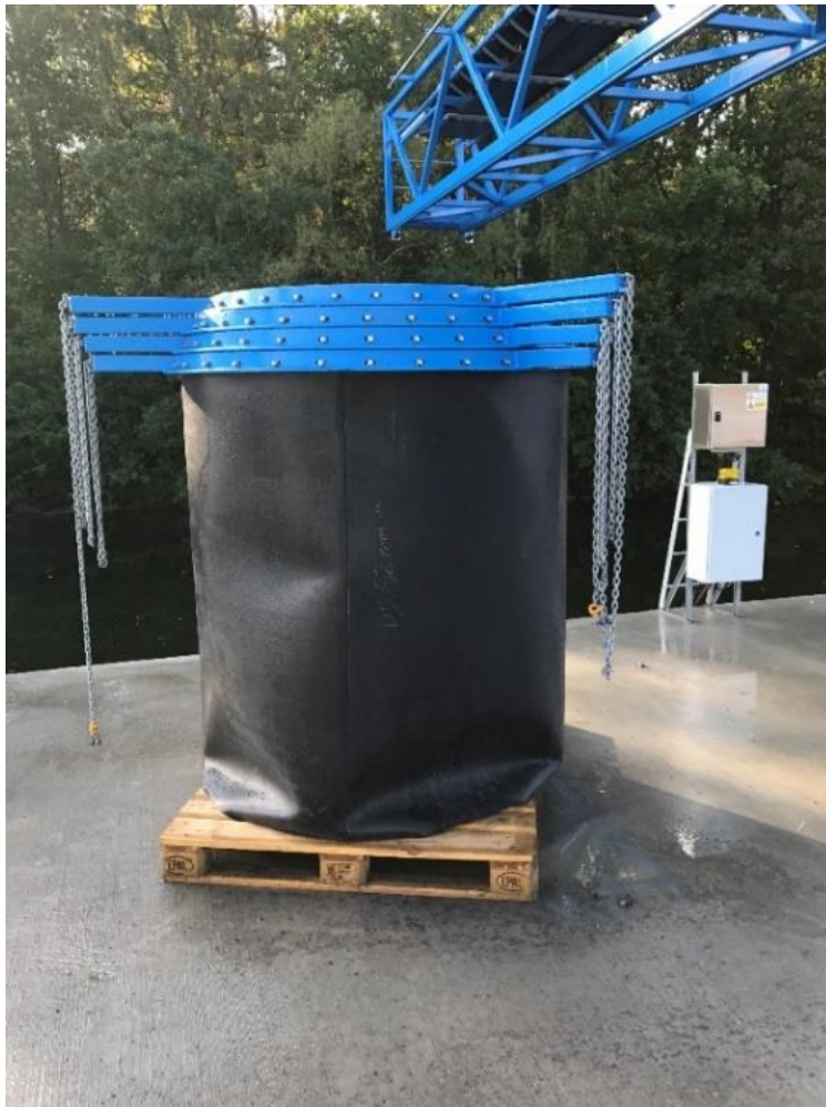
Figur 8. Flexibelt, höj- och sänkbart, rör som pga. av perfekt anpassning mellan lastaren och fartygen inte kunde användas.
