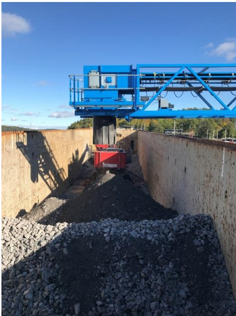
Figur 3. Anpassning av skeppslastaren mot fartyg. Damasken har slitsats för att kunna föras in över kanten till lastutrymmet.
