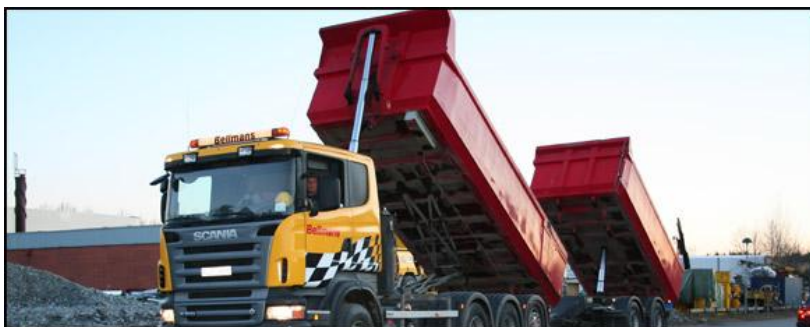
Figur 4.1 visar 4-axlad lastbil (Tridem) + kärria, lastar ca 31 ton
