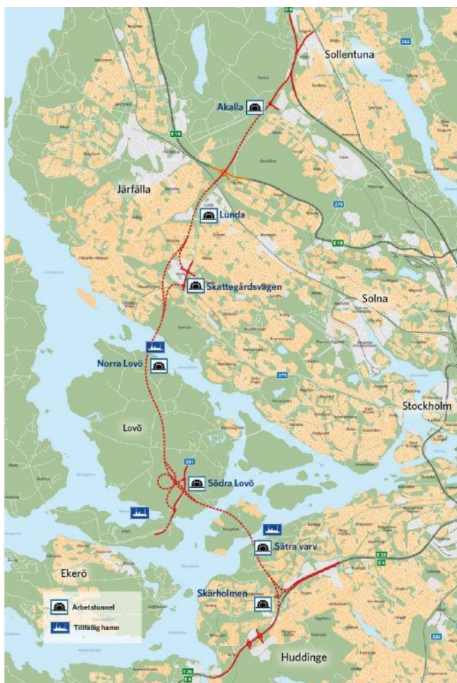
Figur 1. Förbifart Stockholm är en ny sträckning av E4 väster om Stockholm. Under byggtiden byggs tre tillfälliga hamnar för att kunna skeppa bergmassor på vatten.
