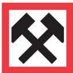
Figur 8.2 Varningsmärke S107 (märket anger att arbeten i eller vid vatten pågår och att arbetena påverkar sjötrafiken)
