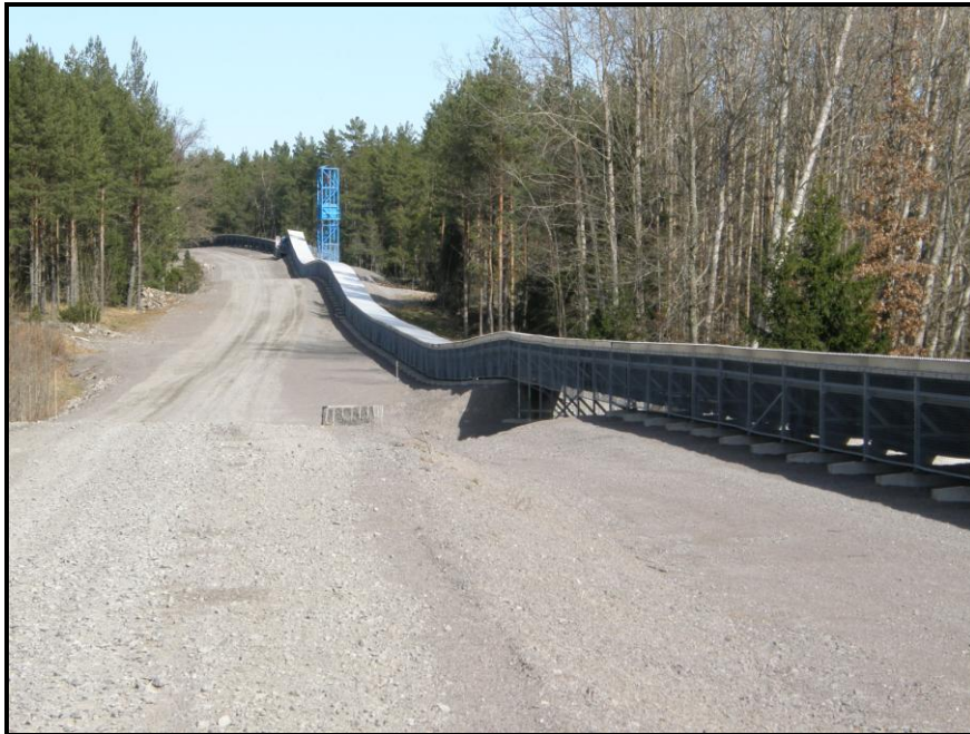
Foto 5.2 Exempel på bandtransportör på mark och med undergång för viltpassage. Vägen på fotot byggdes ursprungligen för dubbelriktad trafik med dumprar, vägen till den nu aktuella tillfälliga hamnen kan göras smalare. I bakgrunden syns ett motviktstorn för reglering av bandspänningen. (Foto: Kjell Windelhed, VV)
