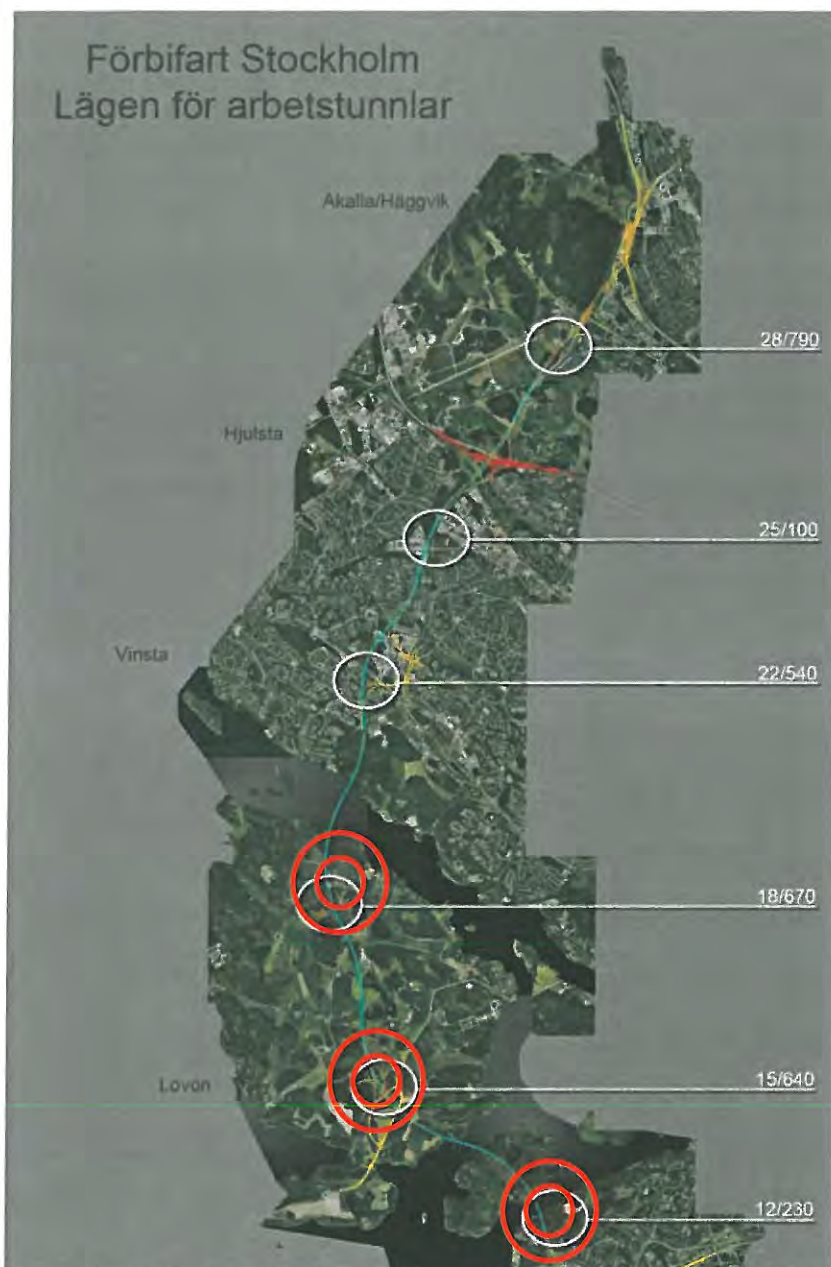
Figur 2 Fördelning och principiell lokalisering av arbetstunnlar för byggandet av Förbifart Stockholm, De tre som är så belägna att det är möjligt att använda transporter till sjöss är markerade med rött.
