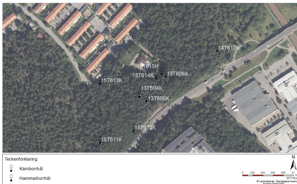
Figur 3.4. Kärnborrhål och hammarborrhål Vålberga
