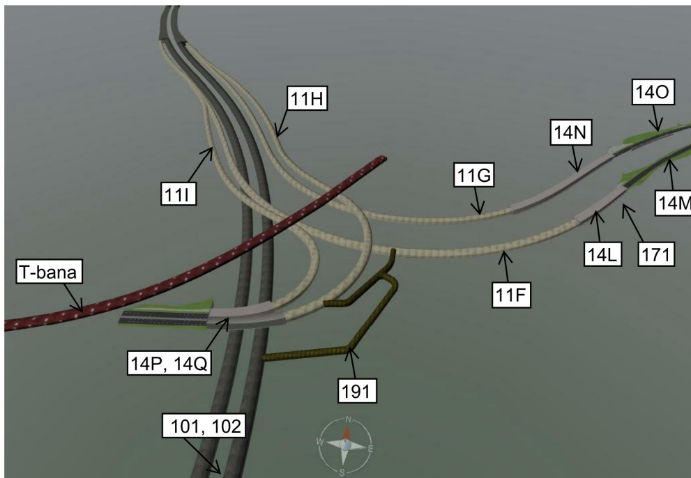
Figur 12.2. 3-D modell över trafikplats Kungens kurva med anläggningsnummer för de delar som innebär vattenverksamhet (siffrorna hänvisar till PM Hydrogeologi).
