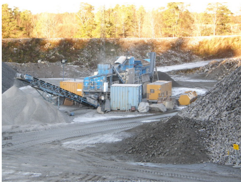
Figur 3 visar en mindre kross- och siktanläggning.
