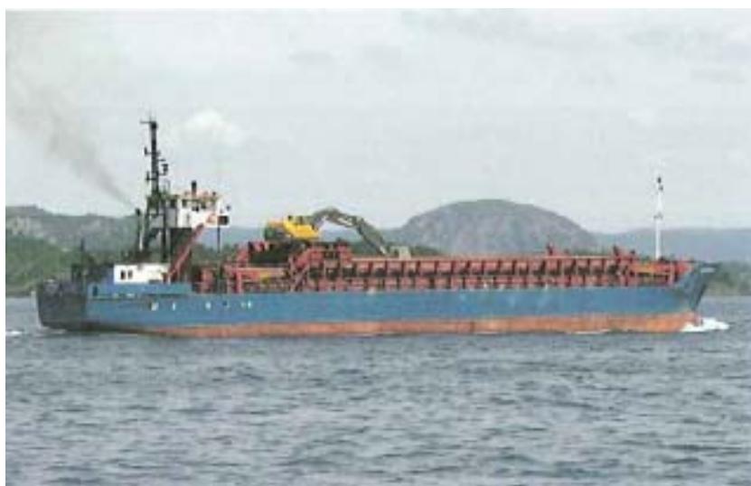
Figur 6 visar Norstones fartyg Falksund som är på 1500 ton, 75 m långt och dryga 10 m bred. Djupgåendet är 3,4 m. På bilden kan den däcksmonterade grävmaskinen ses.
