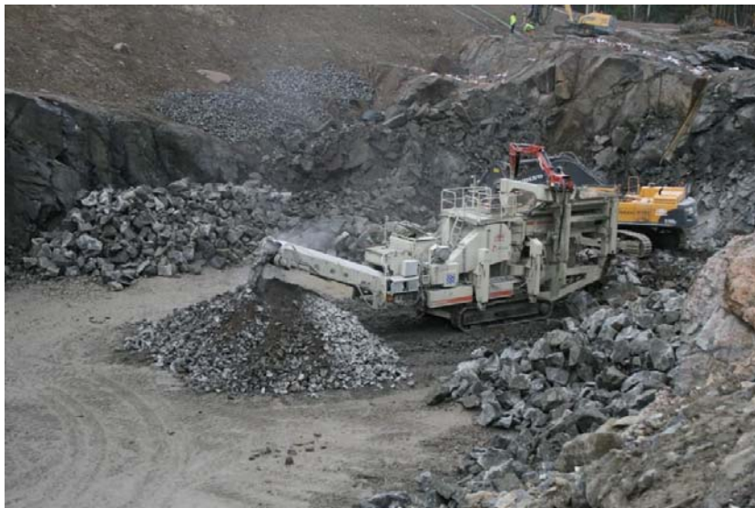
Figur 1 visar en mobil kross lämplig för stationärt bruk under jord.
