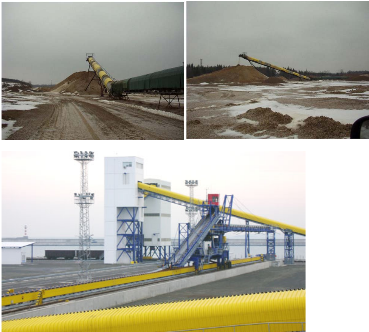
Figur 4 visar exempel på täckta transportband.
