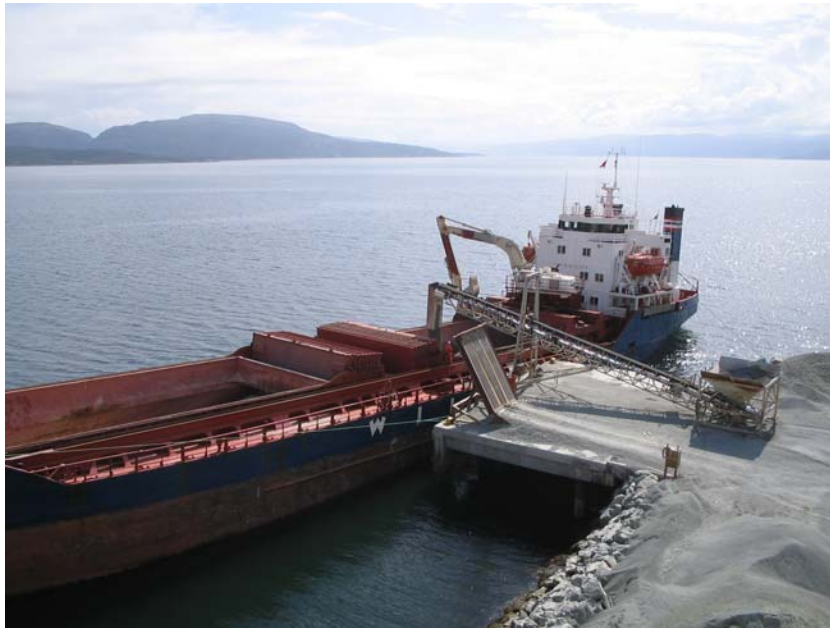
Figur 7 visar fartyget förtöjt vid en kort lastningskaj. För att fördela lasten i lastrummet förhalas båten för- och akterut.
