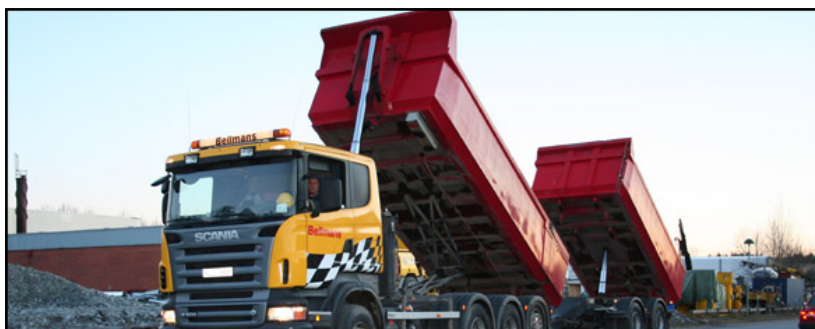
Figur 5 Lastbil och kärra som lastar ca 30 ton.
