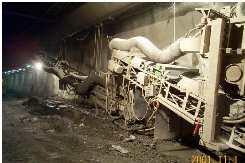
Figur 2 visar en mobil kross under jord.
