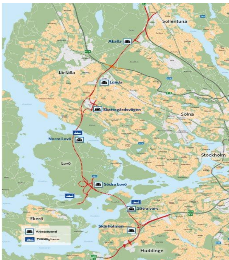
Figur 1. Förbifart Stockholm är en ny sträckning av E4 väster om Stockholm. Under byggtiden byggs tre tillfälliga hamnar för att kunna skeppa bergmassor på vatten.
