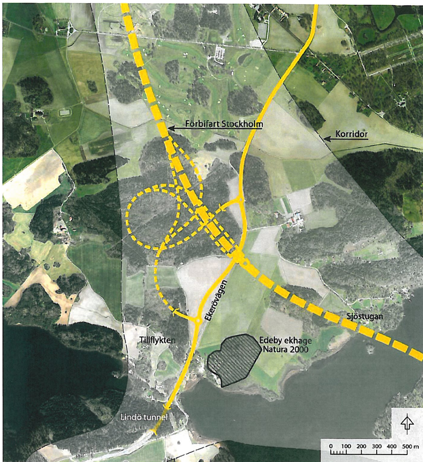
Figur 1 Utformning av trafikplats på Lovö enligt alternativ 1. Streckade gula linjer representerar tunnelförlagda delar (tjock linje = huvudtunnel, smal linje ramptunnlar) och heldragna linjer är ytförlagda vägar. Den gråa ytan redovisar den korridor Förbifart Stockholm fått i och med tillåtlighetsprövningen.
