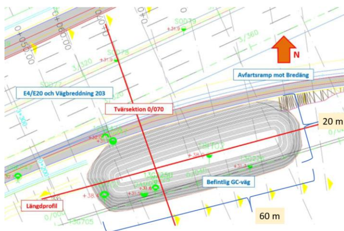
Figur 4 Dagvattendamm 28F (östra dammen)
