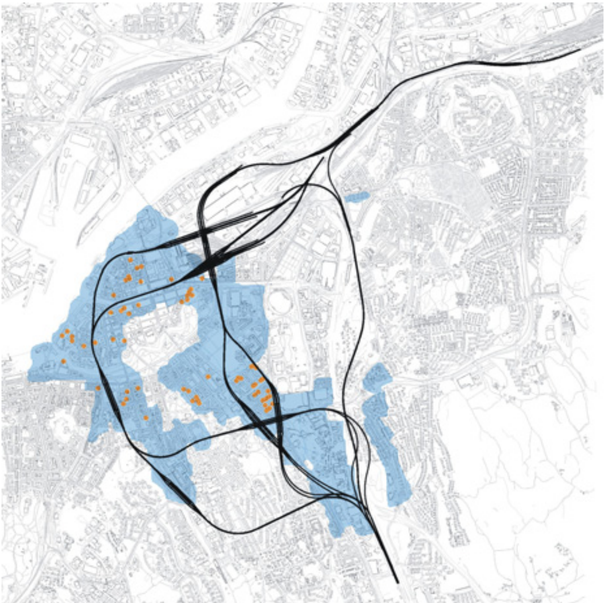
Figur 7 Sättningsskador. Orange markering visar synliga skador på byggnader. Blå infärgning markerar inventerat område
