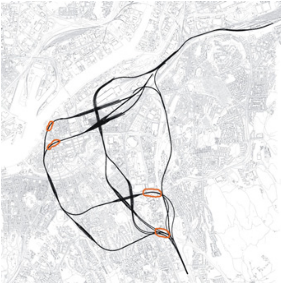
Figur 9 Tunnelavsnitt med risk för dämningseffekt.
