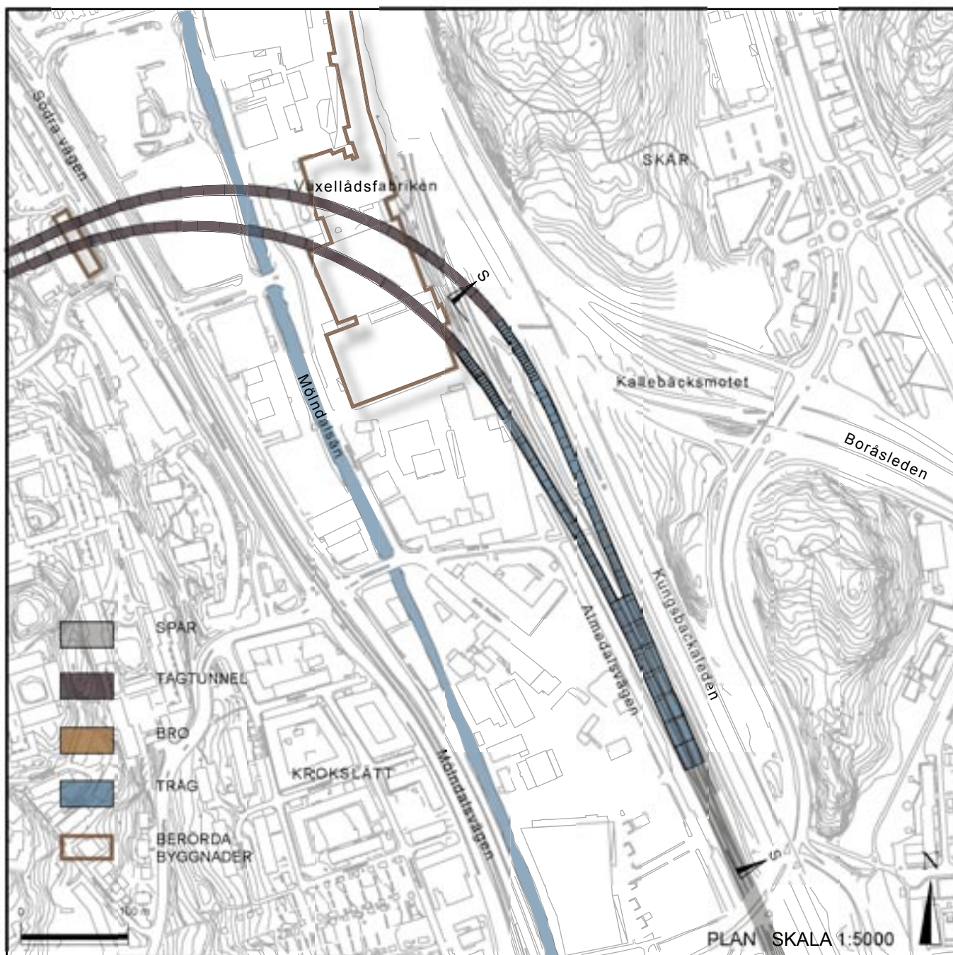
6.3 Tunnelmynning och tråg i Almedal alternativ Växellådsfabriken
